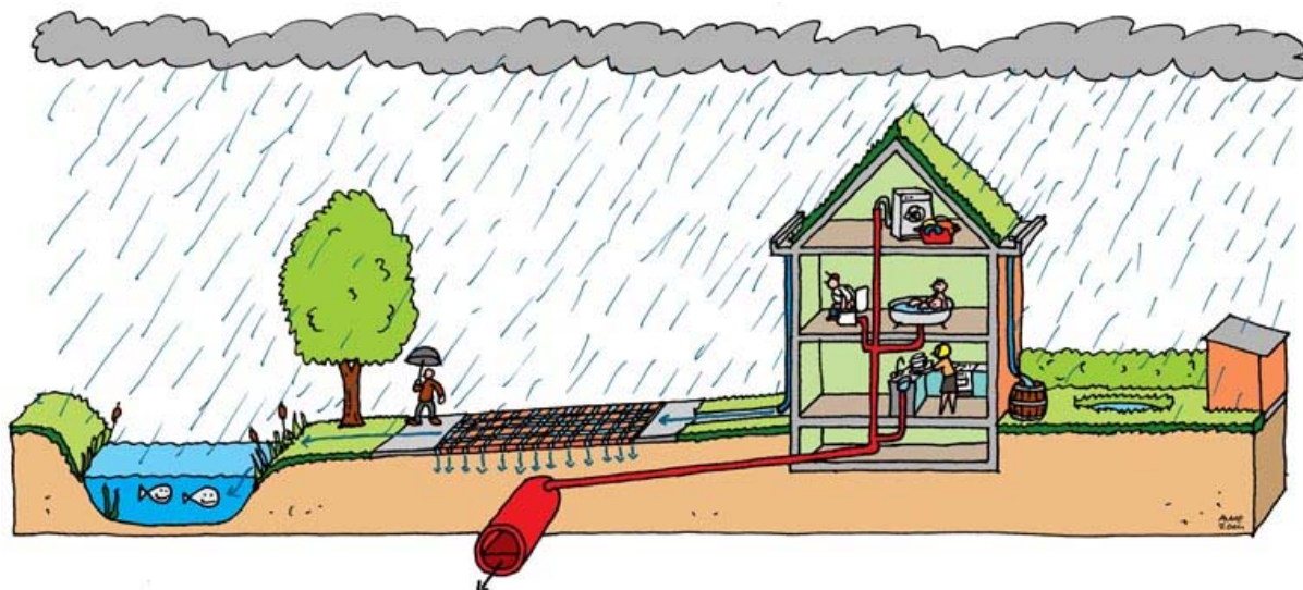
Figuur 5: Het rioolstelsel met gescheiden afvoer van regenwater
