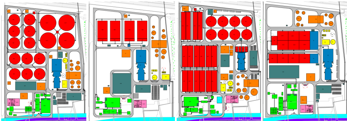
Figuur 2: Plotplannen van de kansrijke alternatieven: 1a: mUCT+NBT | 1b: mUCT+MBR | 2: AB+ | 3: AGS
