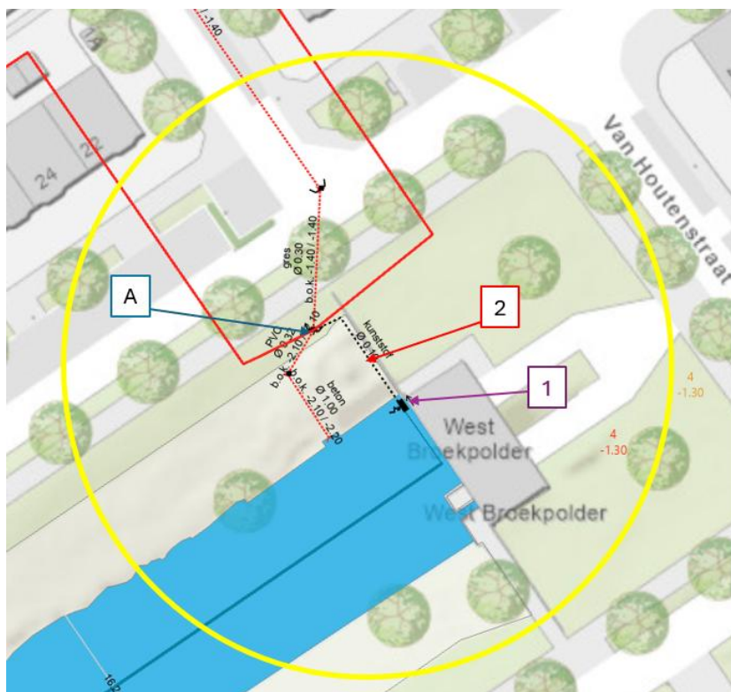
Figuur 5-1: locaties overlaatstuw (A), pompje (1) en duiker (2)
